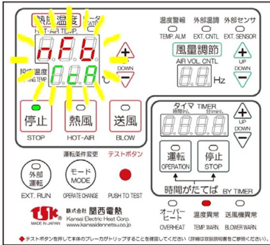
温度異常ランプ(赤)が点灯し、熱風温度部に『nFb』、設定温度部に『TcA』が点滅し、本体のブレーカ(NFB)がトリップしてすべての運転が停止します。
