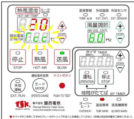
温度異常ランプ(赤)が点灯、熱風温度部に現在の吐出温度が点灯、設定温度部に『Tcc』が点滅し、送風運転状態となります。
