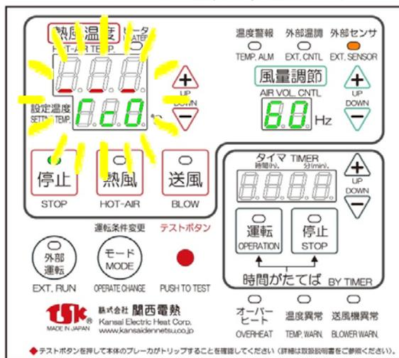
熱風温度部に『---』、設定温度部に各センサの表示が点滅します。
