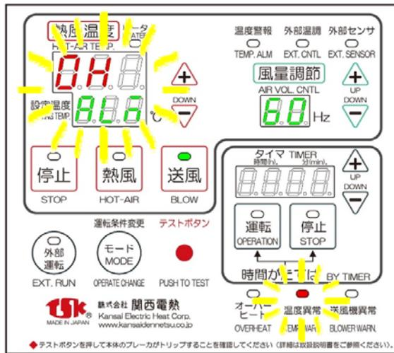
温度異常ランプ(赤)が点滅、熱風温度部に『OH』、設定温度部に『ALM』が点滅し、送風運転状態となります。
