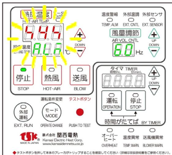
一次側電源からの供給周波数が定格周波数(50/60Hz)の±3Hzを超えた場合に、熱風温度部に『SYS』、設定温度部に『ALM』が点滅し、すべての運転が停止します。
