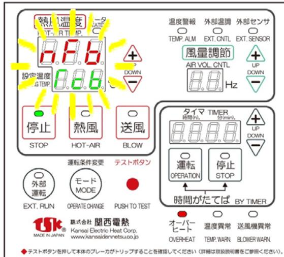
オーバーヒートランプ(赤)が点灯し、熱風温度部に『oVh』、設定温度部に『Tcb』が点滅します。
