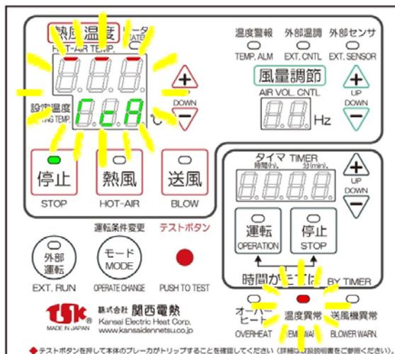
温度異常ランプ(赤)が点滅、熱風温度部に『---』、設定温度部に『TcA』が点滅し、本体ブレーカ(NFB)がトリップしてすべての運転が停止します。
