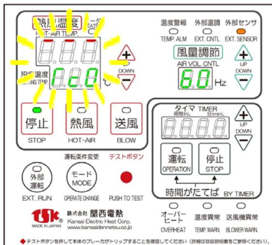
熱風温度部に『---』、設定温度部に『Tc0』が点滅します(外部センサランプは点灯状態です)。
