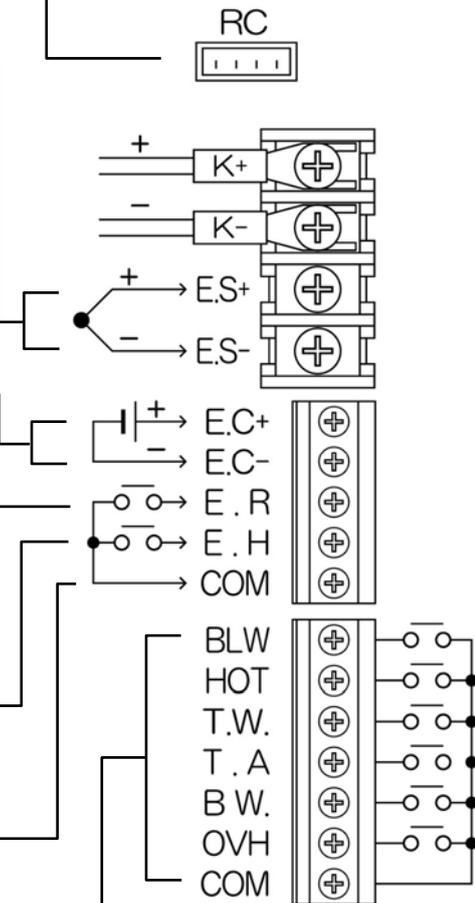
《出力端子》 接点容量DC5V 10mA以上、DC30V 1A以下 出力コモン合計3A以下(無電圧接点信号出力)
