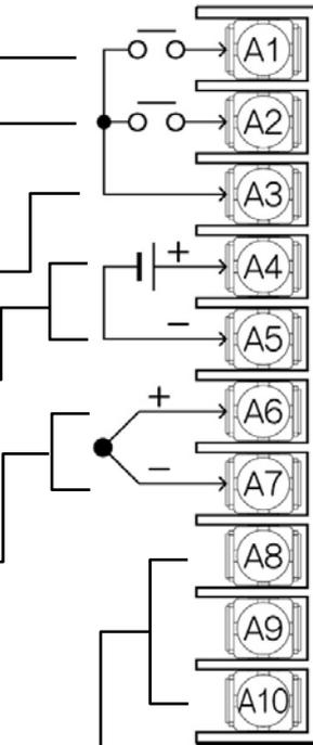
《出力端子》 M3 20P端子台上段 締付トルク:0.5N・m
