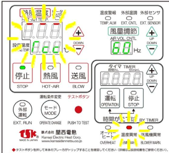
温度異常ランプ(赤)が点滅、熱風温度部に『---』、設定温度部に『Tcc』が点滅し、すべての運転が停止します。
