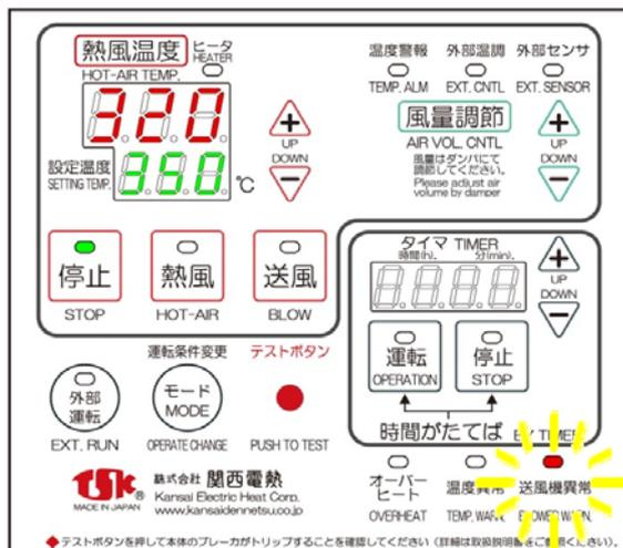
吐出側空気圧力が連続使用可能最高吐出圧力を超えた状態が10分間継続した時、送風機異常ランプ(赤)が点滅し、すべての運転が停止します。熱風温度部と設定温度部には、そのときの吐出温度と設定温度が表示された状態です。
