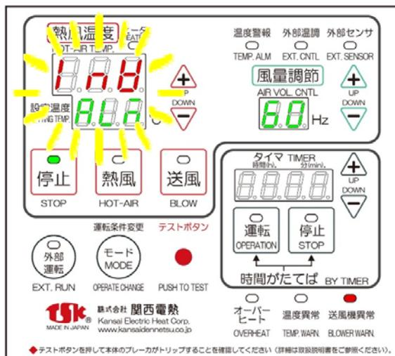
送風機異常ランプ(赤)が点灯し、熱風温度部に『InV』、設定温度部に『ALM』が点滅します。
