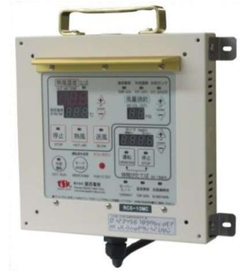
※遠隔ケーブルは遠隔コントローラの上下左右のすべてに取り付け可能です（出荷時は下部取り付け）。各面の入線穴（ノックアウト）を利用し、任意の位置へ取り付けてください。また、取り付け位置を変更した場合は下部の入線穴に付属のゴムプッシングを取り付けて保護してください。
