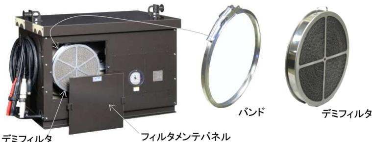
◇フィルタメンテパネルを外すと、デミフィルタが装着されています。メンテナンス(清掃)をおこなう際は、バンドを外しデミフィルタを取り外してから水洗浄してください。取り付けする際は十分に乾燥させてから、デミフィルタを取り付けてください。
