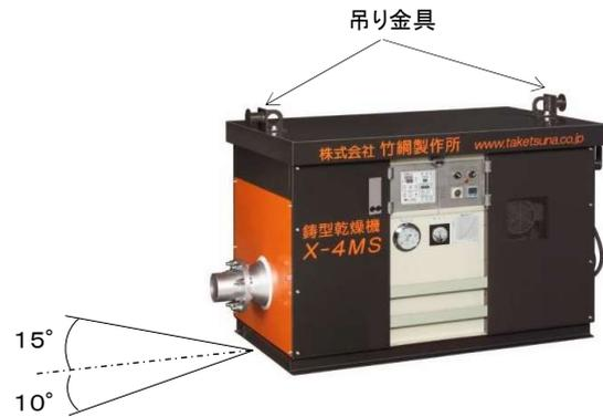
**注意** 吊り金具を使用して鋳型乾燥機を移動される際には、吊り金具に破損・変形・傷・摩耗・サビ・腐食などの異常やボルトナット類の緩みが無いかどうか必ず確認をしてください。
