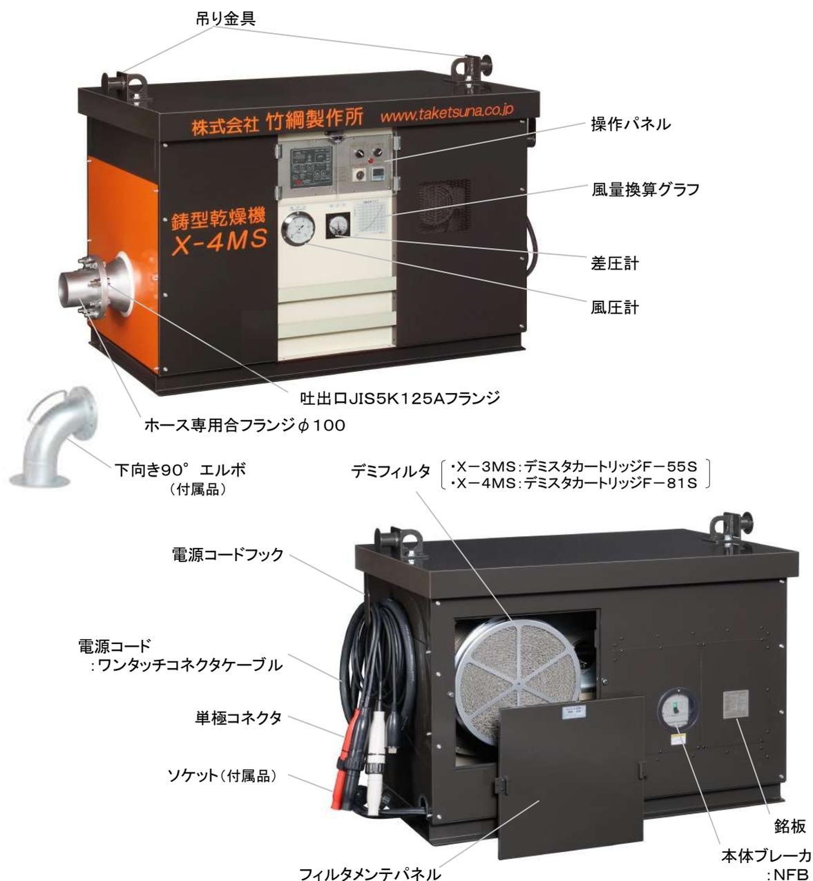
◇本機を鋳型の上に設置し 鋳型主湯口から直接熱風を投入して乾燥させる場合は、下向き90° エルボをご使用ください。
