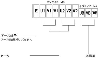
ヒータ電源線(三相200V 2回路:5kW×2回路)を入力してください。電線のサイズは電圧降下を考慮して決定してください。
