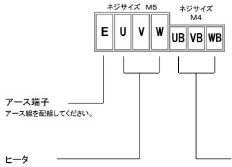
ヒータ電源線(三相200V)を入力 してください。電線のサイズは電圧 降下を考慮して決定してください。
