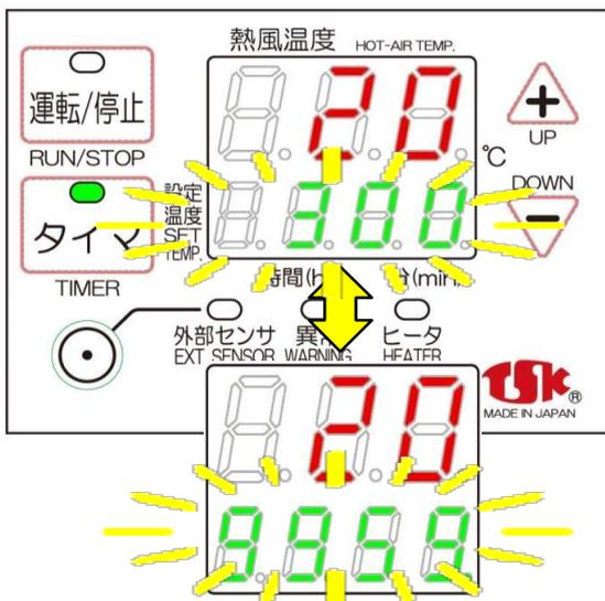
停止時にはタイマランプ(緑)が点灯します。タイマ運転を開始すると設定温度部に設定温度とタイマ時間が交互に点滅し、タイムカウント(タイマ設定時間減算)が開始され、タイムアップ後、熱風運転を開始します。
