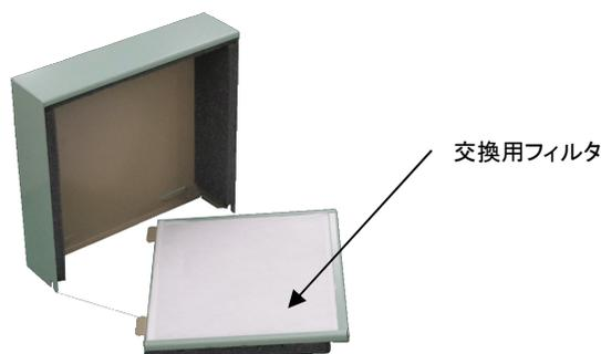
注意：絶対にフィルタを取り外して運転しないでください。塵埃等を吸い込むと送風機が故障します。
