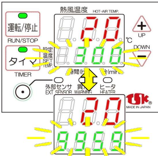
停止時にはタイマランプ(緑)が点灯します。タイマ運転を開始すると設定温度部に設定温度とタイマ時間が交互に点滅し、タイムカウント(タイマ設定時間減算)が開始され、タイムアップ後、熱風運転が停止します。
