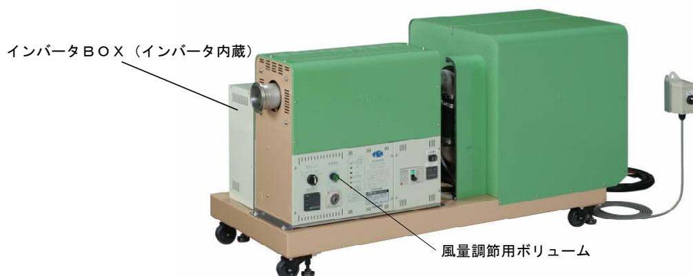
★インバータBOXには内蔵されているインバータが発生する熱を放熱するため、無数の穴が開いています。
