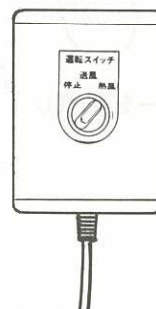
遠隔運転スイッチ
