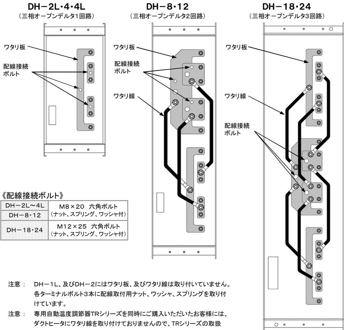
注意： DH-1L、及びDH-2にはワタリ板、及びワタリ線は取り付けいていません。各ターミナルボルト3本に配線取付用ナット、ワッシャ、スプリングを取り付けています。
