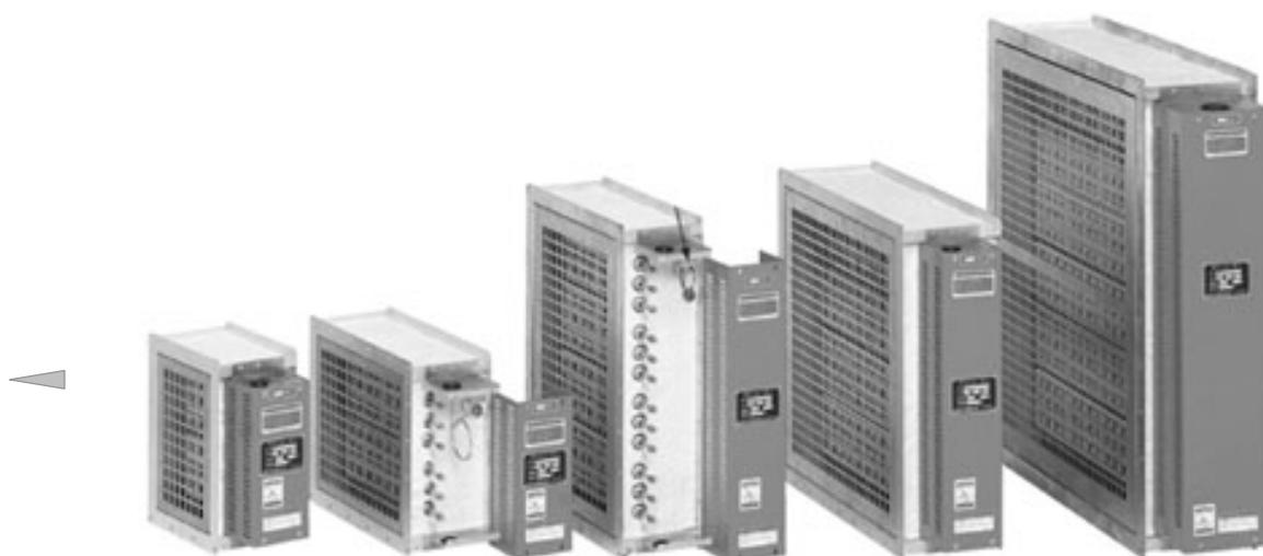
ダクトヒータはエアの通過面積が大きいいため、オプションの角丸テーパダクト、または整流板等を使用して、必ず整流されたエアを供給してください。ダクトヒータ内をエアが均一に通過しないと、その部分の発熱体が異常高温となり、ヒータ断線の原因となります。
