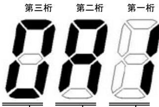
一桁目表示は設置温度異常、圧力異常<sup>※1</sup>、吸入温度異常、吐出温度異常のいずれかの発生状況を、二桁目はオーバーヒート、電源異常、送風機異常、センサ異常のいずれかの発生状況を、三桁目は異常内容の補足コードです。
