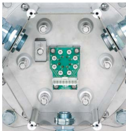
SH71 配線接続部(B視)
