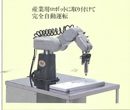
ワークの細い穴の洗浄後の乾燥
