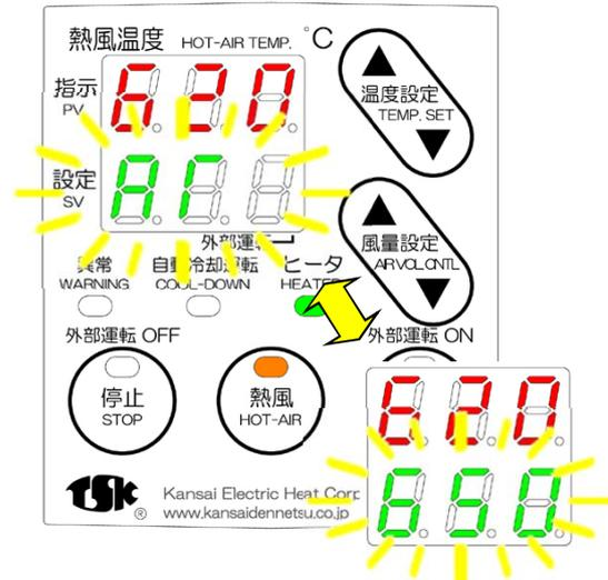
設定SV部に『AT』と設定温度が交互に点滅しながら昇温を開始します。オートチューニングが終了後、点滅が終わり通常熱風運転モードとなります。
