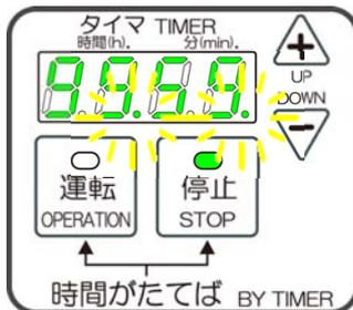
タイムカウント(タイマ設定時間減算)が開始され(ドット表示点滅)、熱風運転をおこないます。タイムカウントが『00.00』になると熱風運転を停止します。また、熱風運転中は熱風ランプ(橙)は点灯し、熱風運転終了後、点滅に切り替わります。
