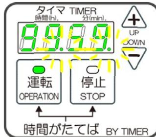
タイムカウント(タイマ設定時間減算)が開始され(ドット表示点滅)、タイムカウントが『00.00』になると熱風運転を開始します。また、タイムカウント中は熱風ランプ(橙)は点滅し、熱風運転開始後、点灯に切り替わります。
