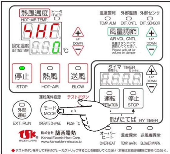
④ 設定温度部にアップダウンキーで任意のホットスタート温度(Max.500℃)を設定してください。
