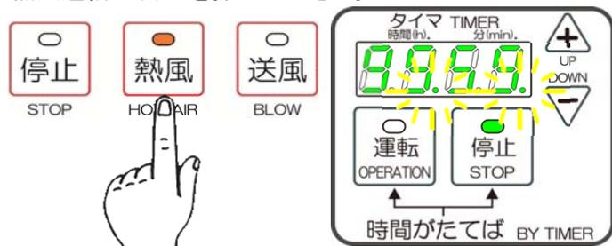
タイムカウント(タイマ設定時間減算)が開始され(ドット表示点滅)、熱風運転をおこないます。タイムカウントが『00.00』になると熱風運転を停止します。また、熱風運転中は熱風ランプ(橙)は点灯し、熱風運転終了後、点滅に切り替わります。
