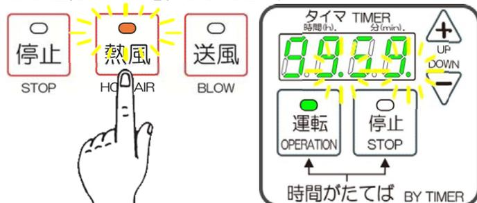
タイムカウント(タイマ設定時間減算)が開始され(ドット表示点滅)、タイムカウントが『00.00』になると熱風運転を開始します。また、タイムカウント中は熱風ランプ(橙)は点滅し、熱風運転開始後、点灯に切り替わります。
